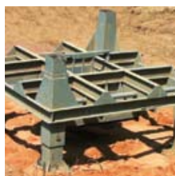
Test przeciwybuchowych paneli podłogowych Von Roll (testowy ładunek wybuchowy to 8kg trotylu)
